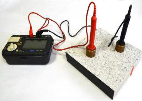
El panel conductivo incorpora como recubrimiento superior un pvc conductor con núcleo estructural de sulfato cálcico o aglomerado de madera, siempre ambos de alta densidad.
